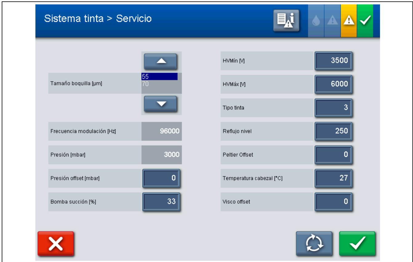
Figura 35: Ventana de menú “Tintensystem > Setup” (Sistema de tinta > Setup)
