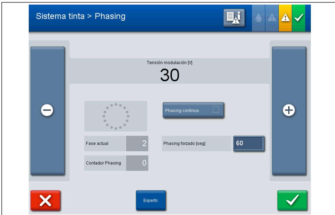
Figura 36: Ventana de menú Sistema de tinta &gt; Phasing
